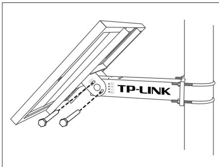
安装太阳能板使用太阳能板配套螺钉。
