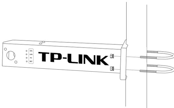
根据指南针或手机指南针类软件确定方向，调整支架朝向，以获得最大的太阳能能量（北半球方位角朝向正南，南半球朝向正北）。
