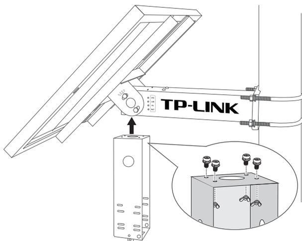
其次，参考如下方式将各类型负载设备固定在支架上。不同类型、支架的复杂接入方式不同，需根据设备实际情况选择相应类型的支架进行安装。
